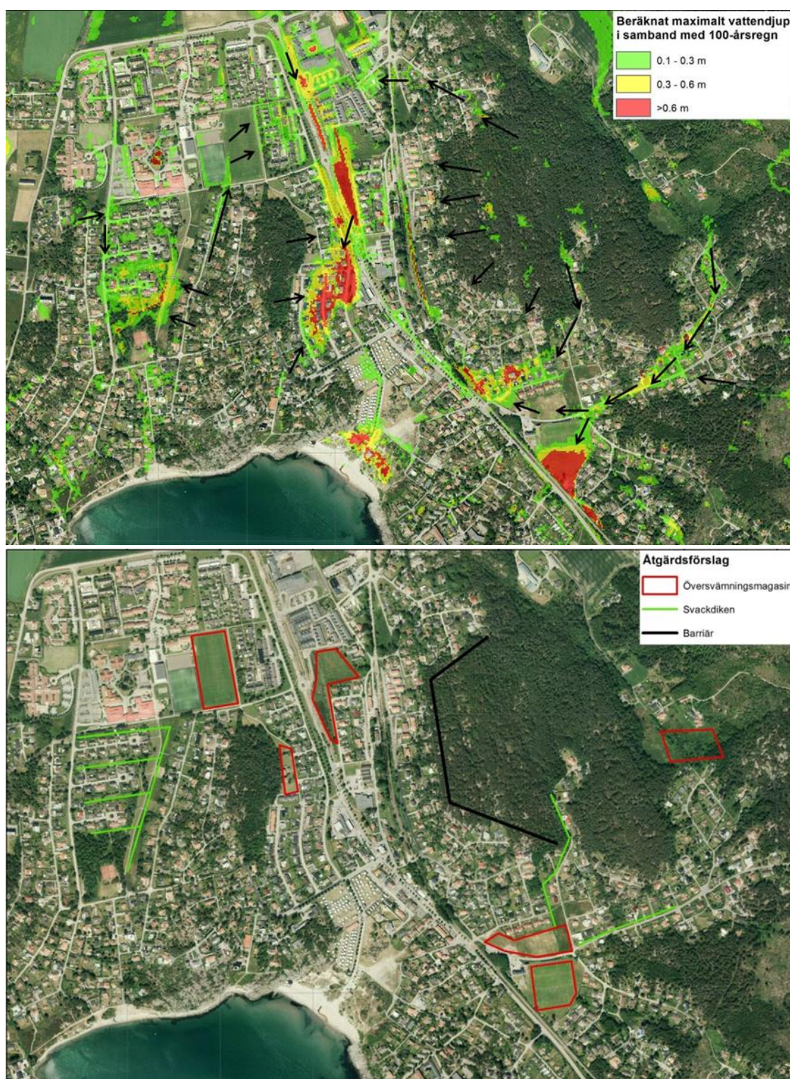
Figur 17 Exempel på beräknade översvänningsdjup och huvudsakliga flödesvägar (övre bild) och föreslagna åtgärder till ytvavrinningsplan.
